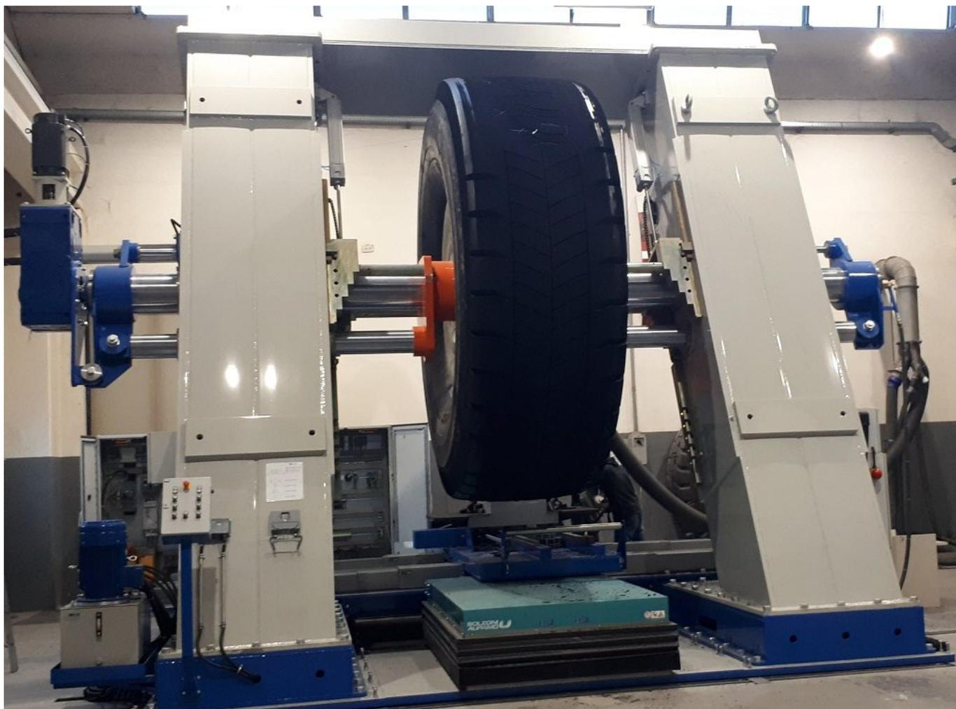
I tecnici di Renova, azienda peruviana leader nella ricostruzione di gomme OTR che arrivano ai 4,5 metri di diametro e 5 tonnellate di peso, si sono recati presso la sede di Ala, in provincia di Trento, di TRM e hanno analizzato l'enorme macchinario. Le dimensioni del Super Eagle OTR 63" sono infatti importanti, con colonne a doppia struttura monolitica dal peso di 15 tonnellate ciascuna. La macchina supera i sei metri di altezza da terra e pesa 50 tonnellate.
