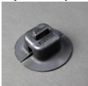
Grande poco più di una moneta, il Cyber Tyre Lean è applicato sulla superficie interna del pneumatico e consente di ottenere dati relativi a pressione, temperatura e carico medio che grava sui pneumatici
