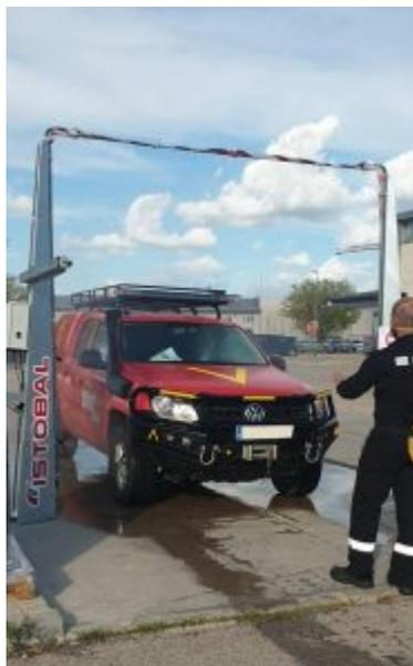
Allo stesso modo, Istobal produce anche archi per la sanificazione esterna di veicoli medici come ambulanze e flotte delle forze dell'ordine con una capacità di sanificazione media di circa 1.000 veicoli al giorno. Questo sistema è progettato per spruzzare i veicoli con biocidi e consente la disinfezione di mezzi anche di grandi dimensioni.
