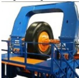
La linea CI-MASTER offre una serie di estrusori per l’applicazione della gomma da vulcanizzare sulla carcassa rasata dei pneumatici fino a dimensioni di 63” di diametro del cerchio (foto)
