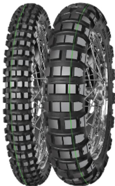
L'**Enduro Trail-Rally MH** per la ruota anteriore è specificamente progettato per garantire stabilità direzionale a qualsiasi angolo di piega e la massima capacità di frenata su terreni medio-duri, come ghiaia pesante e sentieri rocciosi.
