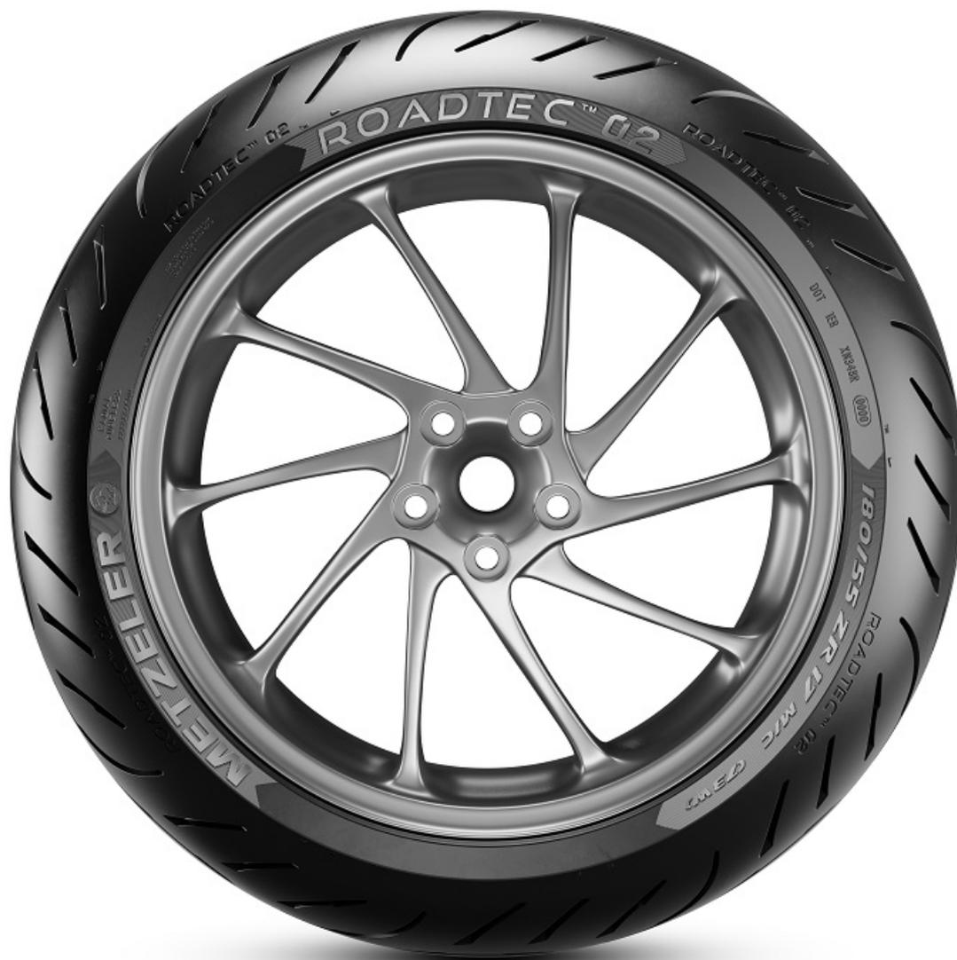
Il disegno battistrada del nuovo pneumatico ROADTEC 02, rispetto al suo predecessore ROADTEC 01 SE, aumenta il rapporto pieni/vuoti, incrementando l'impronta a terra e rendendolo più uniforme al variare dell'angolo di piega, così da garantire una guida più fluida e precisa. Inoltre, una minore presenza di intagli comporta un numero minore di interruzioni sulla fascia battistrada, a vantaggio del comfort acustico.
