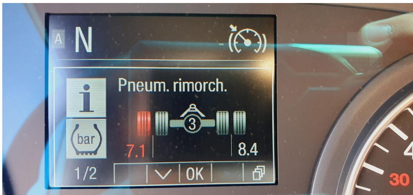
I tecnici di BPW Italia sono infatti riusciti, come si vede nella foto, a inviare il messaggio di avaria della pressione dei pneumatici direttamente sul cruscotto di un camion MAN TGS 18-510 MY 2019, senza dover passare per una connessione remota.
