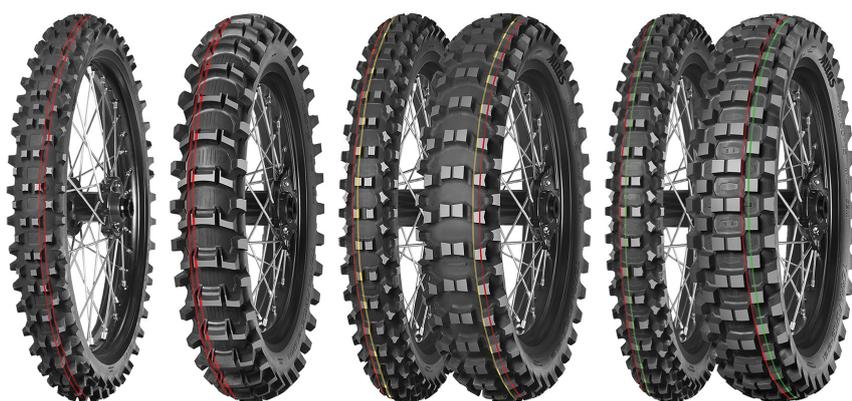
Classificato come NHS (Not for Highway Service), il Sand 2 è identificato dalle sue caratteristiche doppie strisce rosse e viene fornito solo come equipaggiamento posteriore. Può essere utilizzato con il pneumatico anteriore Mitas Terra Force-MX Sand o Terra Force-MX SM.
