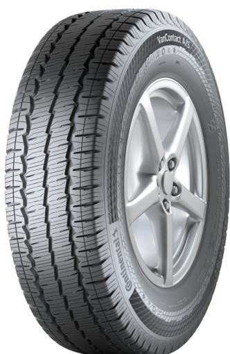
Il design del battistrada del VanContact A/S presenta un gran numero di lamelle, ampie scanalature laterali e ampie scanalature longitudinali sulla spalla. Ciò si traduce in una migliore distribuzione e rimozione dell'acqua e garantisce prestazioni di frenata, aquaplaning e trazione migliori sul bagnato. Ulteriori lamelle sulla spalla, che si incastrano nella superficie stradale innevata, garantiscono prestazioni sicure sulla neve.
