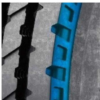
Il battistrada Triangle TB576 è stato progettato tenendo conto delle esigenze di una moderna flotta di gru mobili. Il design a costole rinforzate diritte consente eccellenti caratteristiche di maneggevolezza, un alto livello di comfort di guida e una migliore efficienza di carburante alle alte velocità.
