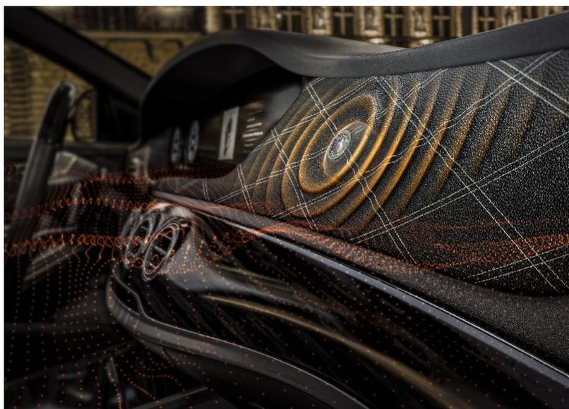
Ac2ated Sound induce vibrazioni nelle superfici esistenti nel veicolo, eliminando la necessità di altoparlanti convenzionali. Insieme all'algoritmo audio 3D integrato di Sennheiser, il
