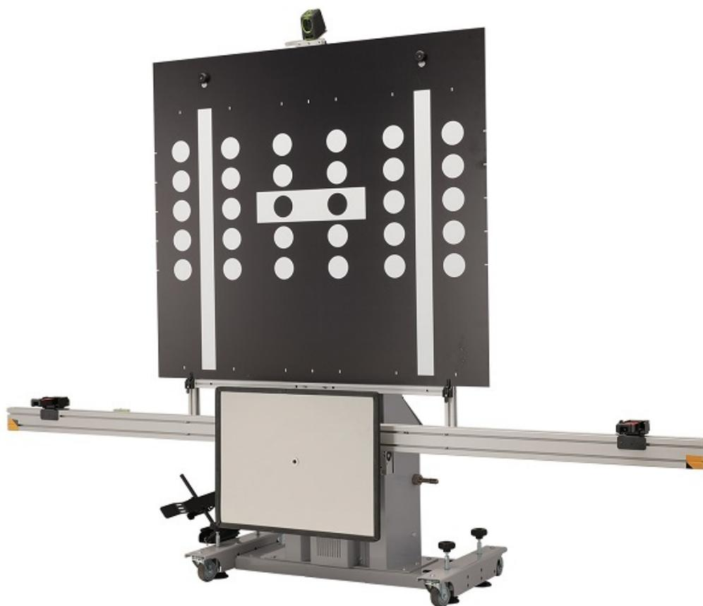
Attraverso le **telecamere** o i **sensori CCD dell'assetto** è possibile allineare il sistema PROADAS rispetto al veicolo da calibrare. Al termine della procedura di assetto, **il software controlla la presenza di sensori ADAS e trasferisce le informazioni del veicolo al software PROADAS via wifi**, evitando perdite di tempo da parte dell'operatore nel selezionare nuovamente il veicolo in banca dati.
