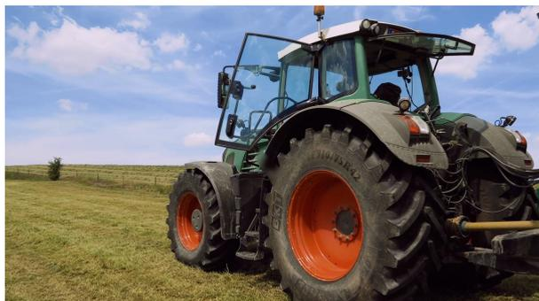
Agrimax Force rappresenta una soluzione vincente per i trattori ad alta potenza sopra i 250 hp: un concentrato di efficienza, resistenza, flessibilità ma anche e soprattutto velocità. Infatti, questo pneumatico è caratterizzato da un indice di velocità D, che permette al macchinario di viaggiare fino a 65 km/h senza modificare le pressioni di gonfiaggio nei passaggi da campo a strada.
