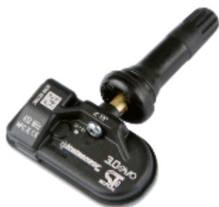
Infine si aggiunge alla gamma dei ricambi e dei service kit, la valvola in metallo per Italsensor 3.0evo color titanio (oltre a quella argento e quella nera) per permettere di avere lo stesso colore di molti cerchi in lega oggi in circolazione ed una nuova valvola snap-in in gomma con innesto universale che oltre a sostituire la valvola del sensore Italsensor e italsensor 3.0evo si adatta anche alla maggior parte dei sensori originali e universali di altri brand.
