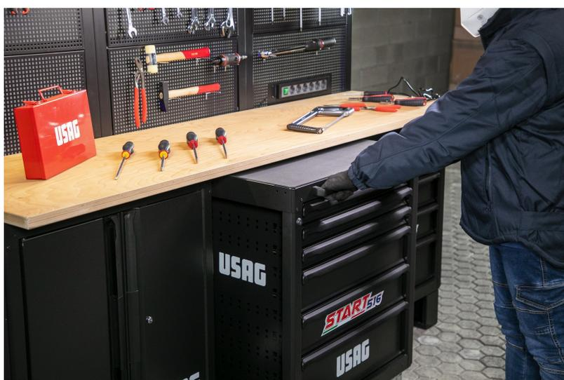
L'ampio piano di lavoro può essere in legno o in acciaio zincato e regolabile su due altezze differenti (842 o 1.006 mm.).
