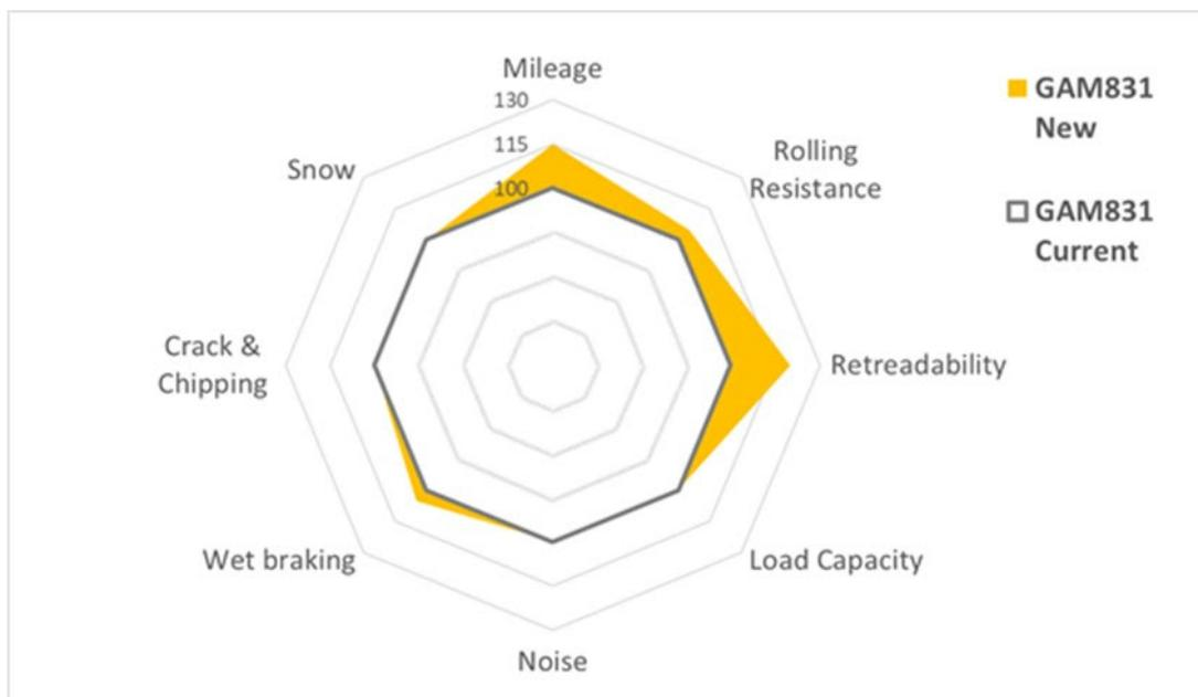
*Comparazione del Giti GAM831 di nuova generazione con il precedente pneumatico*
