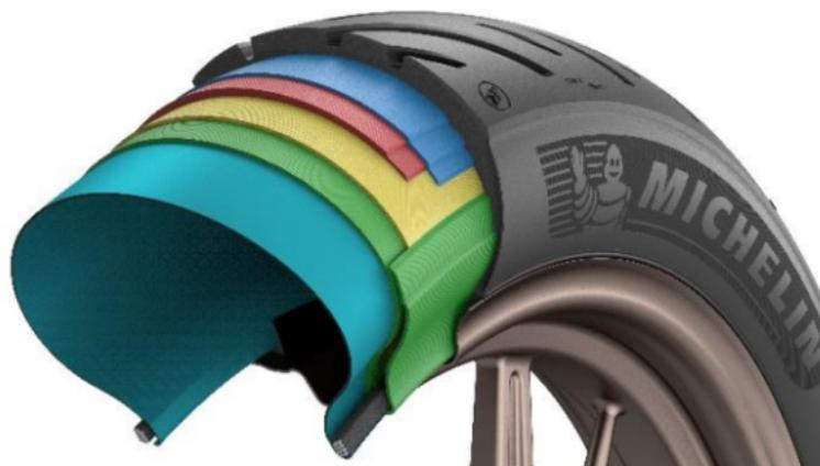
Michelin afferma che il design della carcassa del Road Classic gestisce tutti questi requisiti utilizzando due strati Bi-NST direttamente sotto il battistrada, per ridurre la crescita delle forze centrifughe all'aumentare della velocità, che a sua volta mantiene una zona di contatto di forma costante con la strada.
