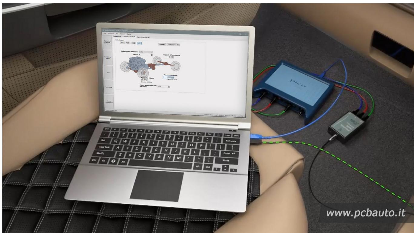
Il Kit si collega a qualsiasi PC portatile con sistema operativo Windows ed i sensori si posizionano vicino a lato guida dove viene riscontrato il problema. Il programma chiederà alcune informazioni del veicolo come dimensioni ruote, tipo di trazione, tipo motore ad esempio se disponiamo di un 4 cilindri, V6 etc. poi dalla presa diagnosi EOBD si collega un'interfaccia all'USB per consentire la lettura di giri motore e di velocità durante tutta la prova.
