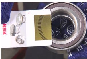
I tecnici delle autofficine possono capire se un cuscinetto per mozzo ruota è dotato di encoder utilizzando una scheda di test di NSK. La stessa scheda consente di verificare se i poli di un cuscinetto montato siano danneggiati (quando il risultato non appare come nell'immagine a lato) e, quindi, se vi siano problemi con il segnale dell'ABS.
