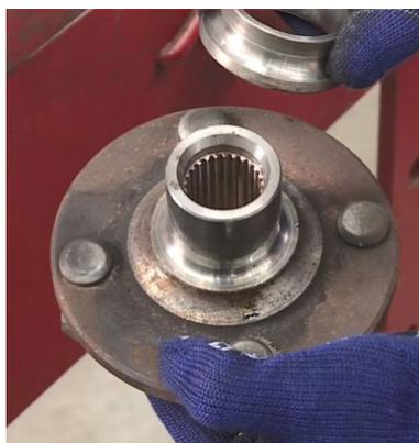
Sono molti i consigli generali da ricordare per questa procedura, ad esempio maneggiare con cura tutte le parti della sospensione per evitare danni inutili. Inoltre, per garantire il corretto montaggio del cuscinetto, è particolarmente importante controllo il mozzo e l'articolazione durante il montaggio, mentre tutte le superfici che saranno a contatto con il cuscinetto devono essere pulite precedentemente.
