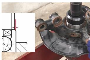
Per esercitare la pressione, utilizzare uno strumento che sia a contatto solo con la faccia esterna dell'anello esterno dei cuscinetti Hub I. Non fare mai pressione sulla tenuta dell'encoder o sull'anello interno, perché questo provocherebbe il cedimento del cuscinetto dopo pochi chilometri di percorrenza. Una volta scelto l'utensile idoneo, mantenete il cuscinetto allineato al foro e premetelo verticalmente per inserirlo nell'articolazione.
