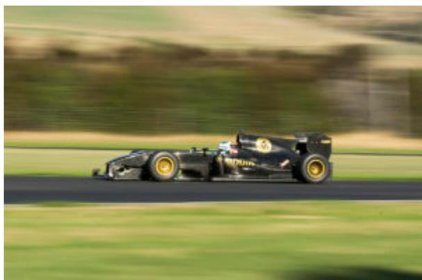
Ora disponibile per l'acquisto in Nuova Zelanda, FZED è alimentata da un motore Cosworth GPV8, che eroga 675 CV e 490 Nm di coppia. Con un peso di soli 609 kg, la costruzione composita ultraleggera in fibra di carbonio dell'auto le consente di accelerare da 0 a 100 km/h in soli 2,9 secondi e di raggiungere una velocità massima di 300 km/h.
