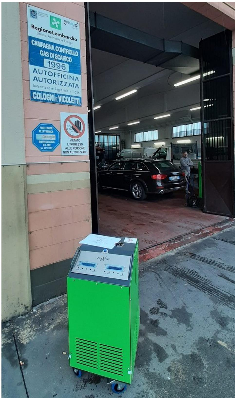
Hy-Carbon pulisce i motori incrostati grazie all'iniezione di gas (idrogeno e ossigeno, ricavati da acqua) dal collettore di aspirazione dell'aria, un solvente naturale e potente ma non aggressivo sui componenti che rimuove i depositi carboniosi. In questo modo viene ridata al motore la potenza originaria, senza l'utilizzo di prodotti chimici, normalmente utilizzati allo scopo. Le emissioni vengono ridotte fino al 50% e i consumi fino al 15%.
