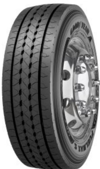
Il FUELMAX S GEN-2 è un pneumatico per asse sterzante sviluppato per offrire un chilometraggio ottimizzato e una maggiore trazione in tutte le condizioni meteorologiche.
