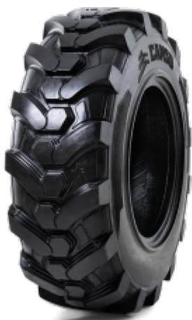
Disponibile in otto misure diverse, il pneumatico multiuso MPT 732 è stato progettato per macchinari come **pale gommate compatte, sollevatori telescopici e terne**. Queste macchine di solito vengono utilizzate in una vasta gamma di condizioni delle superfici, dallo sgombero neve agli scavi e al lavoro nell'azienda agricola, e ogni condizione richiede dai pneumatici trazione, stabilità, durata e qualità di marcia. Per ottenere questo l'MPT 732 è dotato dei seguenti ultimi sviluppi tecnologici:
