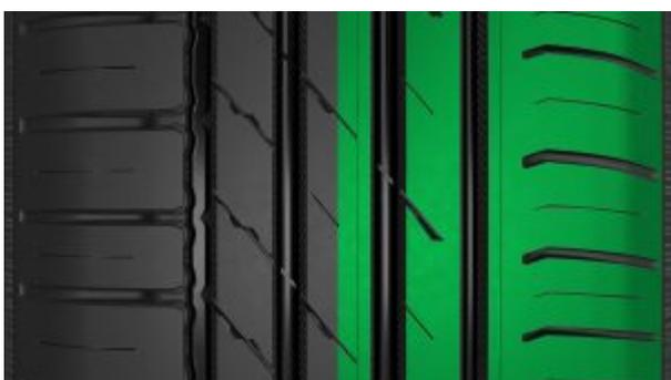
Il controllo del rumore di rotolamento interno ed esterno del veicolo è demandato alla tecnologia Silent Groove Design, un'innovazione posizionata sulle spalle dei pneumatici che migliora il comfort di guida. Il design della superficie, simile a quello di una pallina da golf, controlla il flusso d'aria e impedisce la creazione di un suono sgradevole e ululante. Il design riduce anche la resistenza dell'aria,
