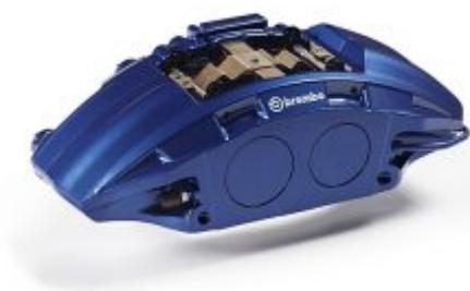
È possibile notare questi inserti cilindrici presenti sulla superficie frontale delle pinze, dove generalmente è applicato il logo. La pinza compatta Brembo ha pistoni dal diametro di 38 e 42 mm; una pastiglia con superficie da 72 cm<sup>2</sup> e uno spessore del materiale d'attrito di 11 mm.
