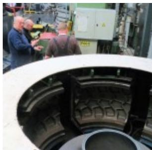
Tutti i pneumatici Techking saranno ricostruiti mediante il processo a caldo
