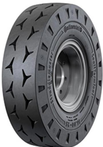
Caption: La nuova gamma di pneumatici portuali di Continental si basa sulla nuova tecnologia V.ply, che unisce i vantaggi della costruzione diagonale e radiale, garantendo grande resistenza e bassa resistenza al rotolamento
