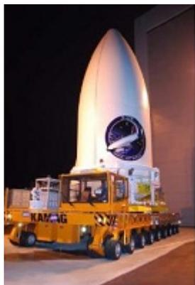
Caption: I pneumatici Continental per autocarro equipaggeranno i due trasportatori modulari semoventi Kamag che operano sul sito di lancio di Cape Canaveral in Florida. Ogni trasportatore Kamag è dotato di 72 pneumatici Continental HTR, necessari per trasportare i carichi (oltre le 90 tonnellate) fino alla rampa di lancio
