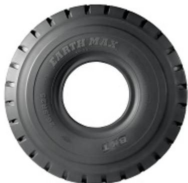
Caption: BKT Earthmax, il pneumatico con struttura "All Steel" progettato per un'ottimale distribuzione dei carichi a terra di dumper e pale gommate, viene presentato al Bauma con i battistrada nelle misure SR 40; 29.5 R 25 e SR 45; 18.00 R 33 in esposizione all'interno dello stand, insieme ad Airomax AM 27 445/95 R 25 e allo pneumatico solido Maglift 7.00-12
