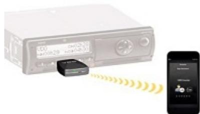
Caption: Per avere informazioni in tempo reale e dati sempre Specifici, Misurabili, Attendibili, Rilevanti, Traducibili (S.M.A.R.T.), il nuovo DTCO SmartLink e l'App VDO Driver trasformano lo smartphone in un'interfaccia di comunicazione tra conducente, tachigrafo e gestore della flotta
