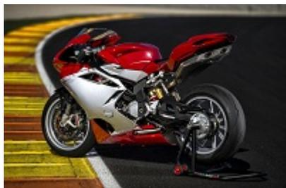
Caption: La regina della casa di Schiranna nella versione base R e RR calzerà in primo equipaggiamento i nuovi pneumatici Diablo Supercorsa SP nelle misure 120/70 ZR17 per l'anteriore e 200/55 ZR17 per il posteriore
