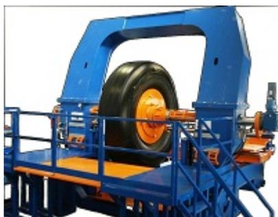
Caption: La linea CI-MASTER offre una serie di estrusori per l'applicazione della gomma da vulcanizzare sulla carcassa raspata dei pneumatici fino a dimensioni di 63" di diametro del cerchio (foto)
