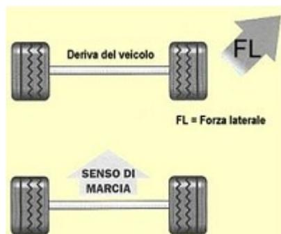
Caption: Figura A: Per tiraggio o deriva si intende lo spostamento laterale del veicolo provocato dalla deformazione trasversale del pneumatico
