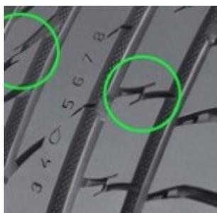
Le lamelle X-Block sulle nervature centrali hanno una doppia funzione: donare stabilità e garantire un morbido contatto con la strada, riducendo la resistenza al rotolamento, il consumo di carburante e la rumorosità
