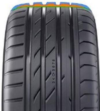
Caption: Lo strato intermedio presente sotto la superficie del Nokian zLine, contiene una miscela di silice nano metrica formata da piccole molecole, che trasmette i movimenti del volante a una velocità notevolmente maggiore rispetto ad altre mescole standard
