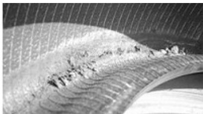
Caption: Fig.2: esempio di dislocatura interna di uno pneumatico per marcia prolungata con pressione zero
