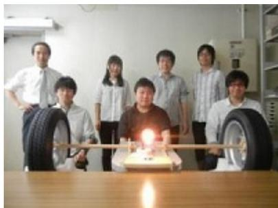
Caption: La prima dimostrazione del progetto di ricerca EVER (Electric Vehicle on Electrified Roadway): una lampadina viene alimentata dall'energia elettrica trasmessa, attraverso i pneumatici, da piastre di metallo a 10 cm di profondità sul manto stradale
