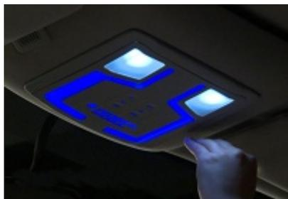
Caption: Grazie all'ultima tecnologia sviluppata da Federal-Mogul, è sufficiente avvicinare la mano al sensore di prossimità capacitivo per illuminare l'abitacolo dell'auto
