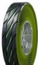
Bridgestone punta sul pneumatico airless come concreta alternativa più ecocompatibile rispetto ai pneumatici tradizionali
