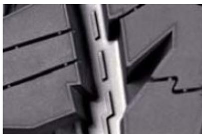
Caption: Gli espulsori di sassi del pneumatico estivo Nokian Rotiiva AT puliscono le scanalature del battistrada impedendo così ai sassi di penetrare a fondo nei pneumatici.
