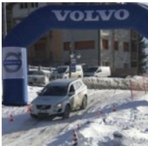
Prova 4: a confronto due Volvo XC60 che effettuano una frenata di emergenza su fondo innevato in leggera discesa con equipaggiamento estivo e invernale a metà usura
