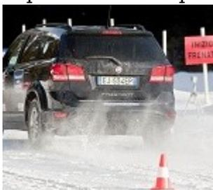
Prova 6: confronto dello spazio di frenata di due Fiat Freemont 1.9 JTD a trazione anteriore, equipaggiate con pneumatici invernali e pneumatici estivi nuovi e catene omologate da 7mm sull'asse trattivo anteriore
