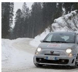
Prova 2: confronto su aderenza, trazione, capacità di frenata, ripartenza, spunto in salita e tenuta laterale in curva tra due Abarth 500 a trazione anteriore con equipaggiamento invernale ed estivo
