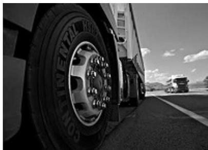
Caption: Il pneumatico per asse anteriore Continental HSR2 XL è già pronto per essere utilizzato negli autocarri di generazione Euro 6, grazie ad una capacità di carico fino a 10 tonnellate
