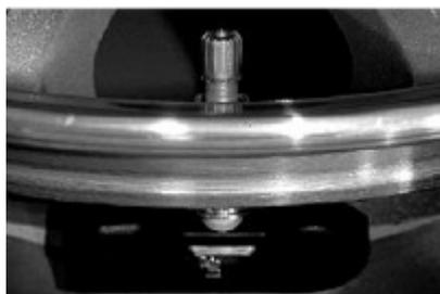
Caption: Figura 2: Esempio di valvola/sensore T.P.M.S. installata con metodo diretto
