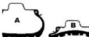
Figura 4: Comportamento dinamico di uno pneumatico Run Flat A rispetto ad uno tradizionale B, in caso di foratura
