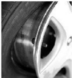
Figura 5: Detallonamento dello pneumatico dal cerchio in fase dinamica
