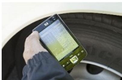
Caption: I sistemi di monitoraggio della pressione dei pneumatici possono inviare i dati di rilevamento ad altri dispositivi elettronici
