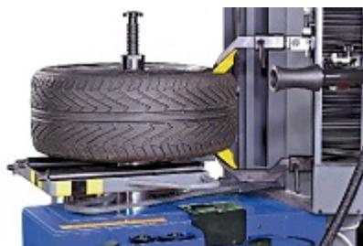
Caption: Lo smontagomme MS 68 NG permette di montare pneumatici per autovetture e autocarri con cerchioni fino a 30" di diametro, sia in acciaio che in lega
