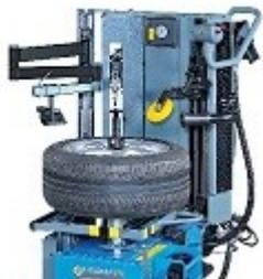
Il nuovo smontagomme MS 68 NG è stato appositamente realizzato per operare con pneumatici di tipo RFT (Run Flat Tyre) e UHP (Ultra High Performance)
