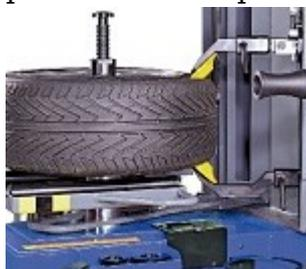
Lo smontagomme MS 68 NG permette di montare pneumatici per autovetture e autocarri con cerchi fino a 30" di diametro, sia in acciaio che in lega
