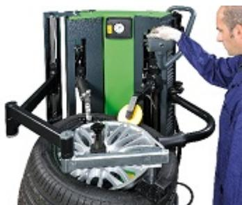
Caption: Con il TCE 4540 Bosch possono essere montati, su cerchi in acciaio o lega leggera, pneumatici di auto e veicoli commerciali da 10" a 30" di diametro e con canale da 2" a 22", con peso fino a 80 kg
