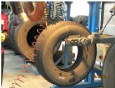
Caption: L'ispezione interna è una delle sette fasi per la ricostruzione di pneumatico
