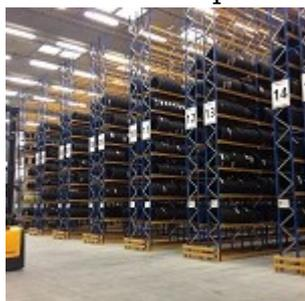
Il nuovo magazzino utilizza un metodo di stoccaggio misto (ceste e scaffalature fisse), un sistema informatico di ubicazione con codice a barre, abbinato ad un sistema filoguidato in corsia dei muletti
